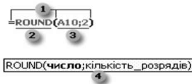
Рис.4.23. Структура опису функції, яка здійснює округлення значень 1 — структура звернення (виклику) функції; 2 — ім'я функції; 3 — аргументи; 4 — підказка синтаксису.
